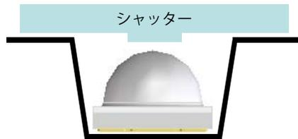
カバーテープを取り外した後、シャッターにより部品がフィーダーを通過してピックアップされる。
