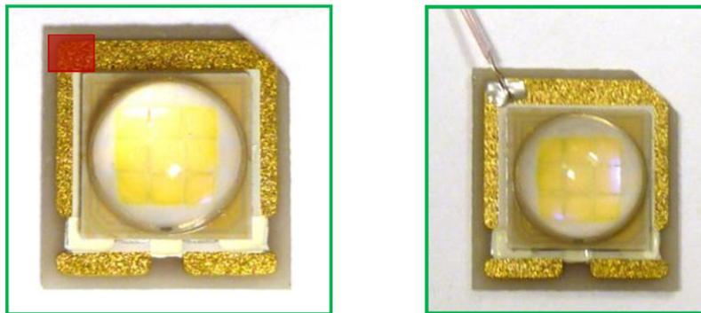
図 10. 熱接触(赤い部分、左図)とTCプローブ取り付け例(右図).
